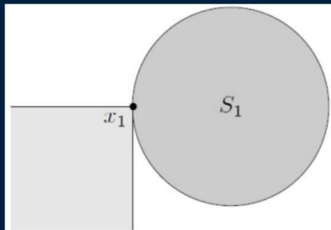
图: 点  $\mathbf{x}_1 \in S_1$  是极小的, 但对于任意  $\lambda \succ 0$ , 它都没有在  $S_1$  上极小化  $\lambda^T \mathbf{z}$ 。但是对于  $\lambda = (1, 0)$  它确实是在所有  $\mathbf{z} \in S_1$  中极小化了  $\lambda^T \mathbf{z}$
