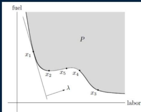
**图：**制造集合  $P$  如阴影所示，表示制造产品所需要的劳动力和燃料。两端深色曲线表示了有效制造前沿。点  $\mathbf{x}_1, \mathbf{x}_2, \mathbf{x}_3$  是有效的。点  $\mathbf{x}_4, \mathbf{x}_5$  不是（ $\mathbf{x}_2$  对应了更少燃料更少人力的方法）。点  $\mathbf{x}_1$  是对应于（正的）价格向量  $\lambda$  的最小成本制造方法。点  $\mathbf{x}_2$  是有效的，但是对于任意价格向量  $\lambda \succeq 0$  都无法通过极小化总成本  $\lambda^T \mathbf{x}$  找到  $\mathbf{x}_2$
